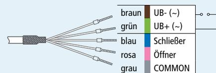
ACHTUNG! Die Betriebsspannung wird intern über einen Brückengleichrichter geführt, d.h. bei Sensoren HSF2 entspricht der Minuspol der Versorgungsspannung nicht dem Bezugspotential des Analogausgangs.
