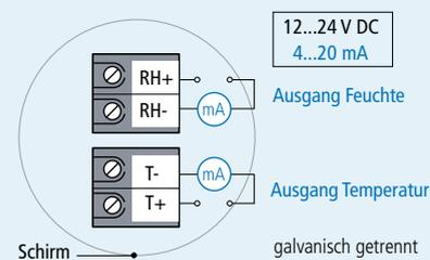
Feuchte und Temperatur mit passiv Messelement CVR
