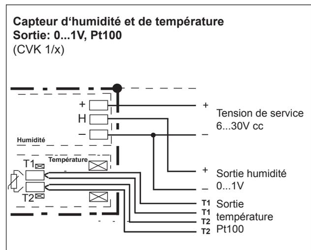
Schéma de raccordement
