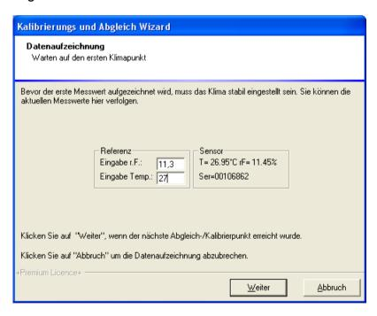
Danach nimmt das Programm 5 Messwerte auf. Dies ist notwendig, um einen Mittelwert zu berechnen, dabei werden kleine Messwertschwankungen kompensiert. Das Programm überprüft weiterhin, ob sich der Sensor dem Klima angepasst hat. Sollte die Messwertdrift innerhalb einer Messung zu groß sein, wird die Aufzeichnung abgebrochen.
