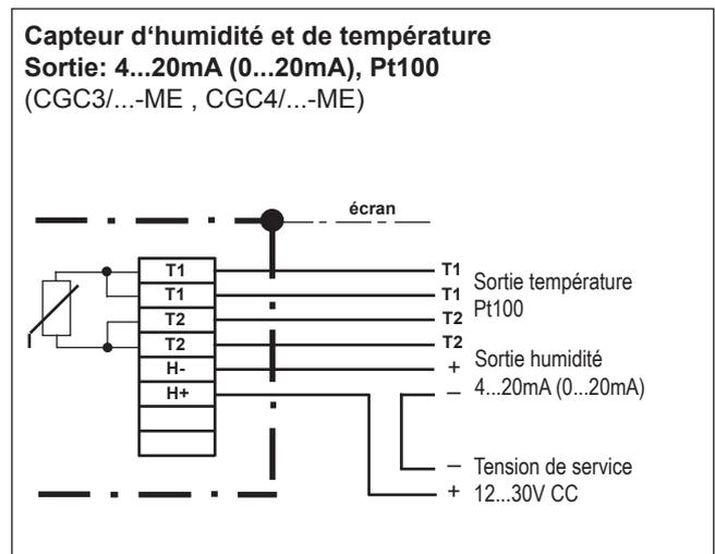
Schéma de raccordement
